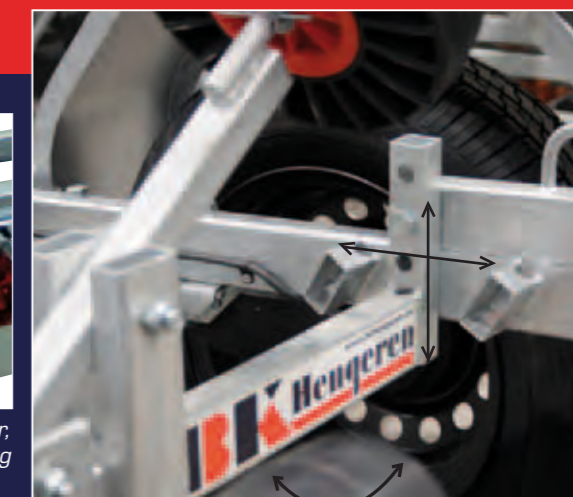
100 % selvjusterende tippvugge som kan justeres i høyde- og lengderetning.
