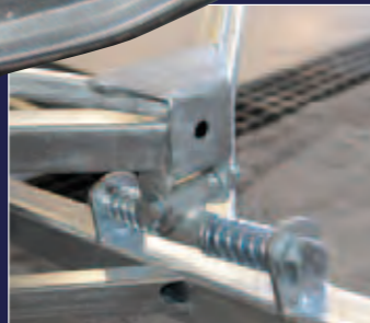
Fjærbelastet drag for myk kjøring.
